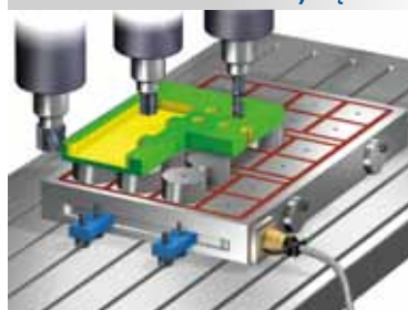
Frezowanie płaszczyzn, wiercenie i frezowanie wycięć
