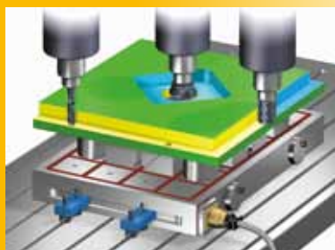
Otočení, hrubování, uvolnění (DEMAG/MAG) a obrábění na čisto 2. plochy
