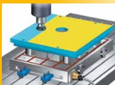
Otočení a obrábění na čisto 1. plochy
